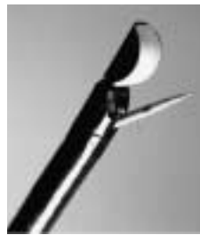
Abb. 1: Endosonoskop mit elektronischem Sektorscanner, über den 3,2 mm - Arbeitskanal ist ein Drainagesystem eingeführt (FG 38UX, HITACHI Medical Systems, Wiesbaden und PEN-TAX Medizintechnik, Hamburg).
